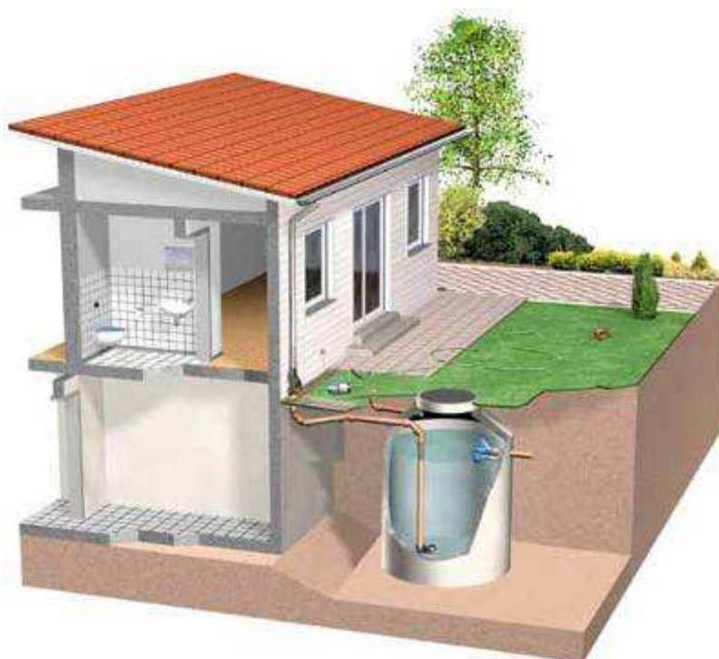
Figura 5.8. Esquema de captação da água da chuva em telhados de residências (Fonte: Technik do Brasil Ltda).
