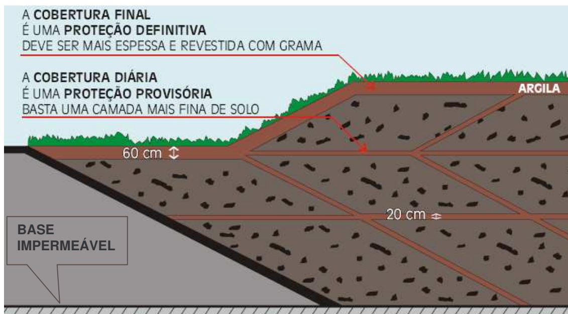
Figura 4.23. Aterro sanitário com base impermeável e drenagem superficial.
