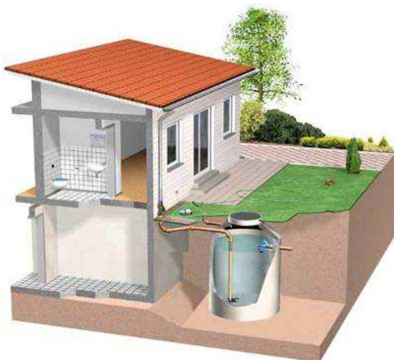
Figura 4.3. Esquema de captação da água da chuva em telhados de residências (Fonte: Technik do Brasil Ltda).
